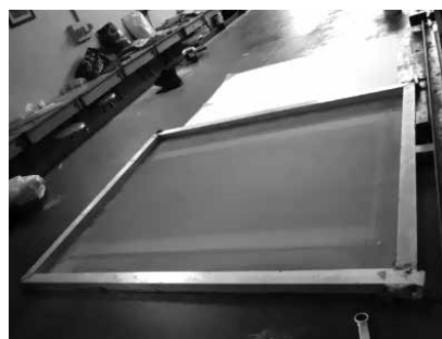
تصویر ۲۰- گذاشتن شابلون روی پارچه
