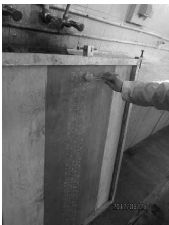
تصویر ۱۶- زدن سخت کننده روی شابلون
